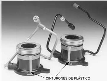
3. Asegúrese que no existan fugas en el sistema hidráulico y por ningún motivo debe doblar o modificar las líneas del sistema. Revise cuidadosamente que el cilindro maestro no esté dañado ya que esto puede ocasionar fallas posteriores.
